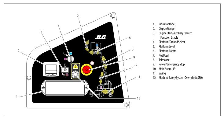
Figure 3-2. Ground Control Console - 400S w/MSSO (CE Only)
